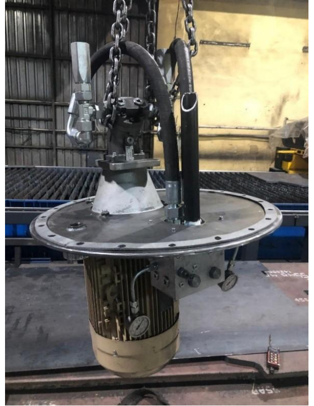
Şekil 10. Elektro-Hidrolik Blok Montaj-2
