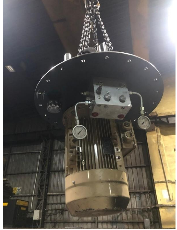
Şekil 9. Elektro-Hidrolik Blok Montaj-1
