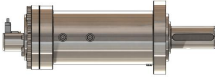
Şekil 9. Hidrolik Döner Eyleyicinin Katı Model Tasarımı
