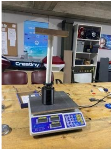
Şekil 6 Mıknatıs Kuvveti Hesaplama Test Düzeneği
