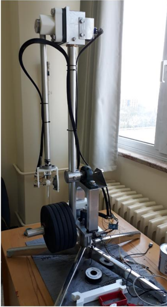
Şekil 8. PCMM prototipi - dengeleme ağırlıkları
