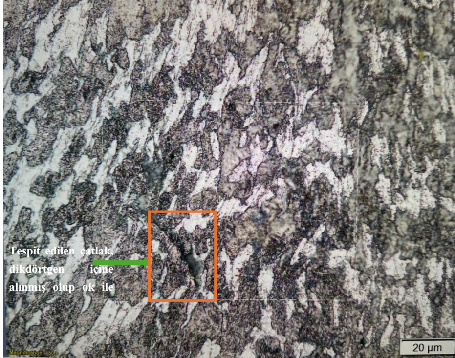
Şekil 6. Yağsız haddelenmiş ve kullanım sırasında şaftı kırılmış rot başının şaftı üstünde başka bölgesinin dış dibinde tespit edilen çatlak
