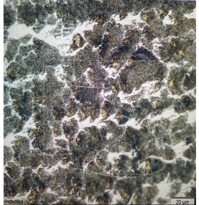
(b) Yağlı üretilen ve kullanılmamış rot başının şaftının diş dibinden alınmış görüntü. Çatlak yok.
