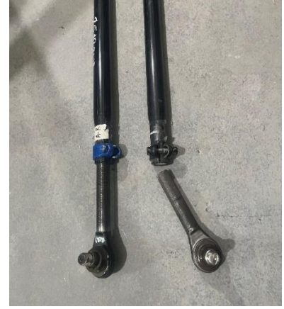
(b) Yorulma testi sonucu kırılan yağsız diş açılan rot başı gövdesi ve kırılmayan yağlı gövdeli rot başı gövdesi
