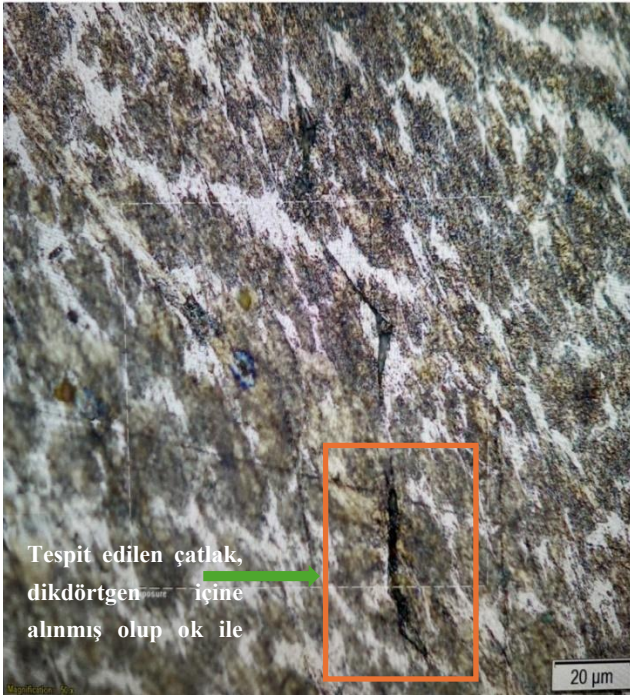
(a) Yağsız üretilen ve kullanılmamış rot başının şaftının diş dibinde tespit edilen çatlak
